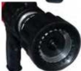
Стволы пожарные ручные СРП-50р предназначены для формирования и направления сплошной или распыленной струи воды, воздушно-механической пены средней или низкой кратности, а также для перекрытия подачи огнетушащих веществ. Стволы имеют бесступенчатую регулировку угла факела распыла от прямой компактной струи до защитной завесы в 120°, а так же регулировку расхода воды с фиксированным положением позиций. Стволы применяются для комплектации передвижной пожарной техники.
