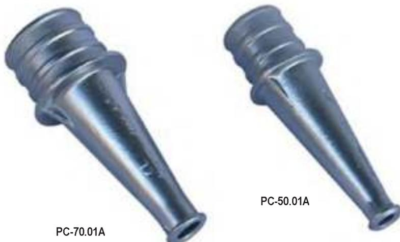
Пожарные ручные стволы для внутренних пожарных кранов РС-50.01А и РС-70.01А ТУ У 14317031.011-96 предназначены для постоянного крепления на конце пожарной рукавной линии. Служат для формирования и направления сплошной струи воды на очаг пожара.
